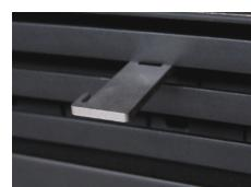
**Klíč Aduro:** Tento klíč je součástí dodávky a usnadňuje ovládání přívodu sekundárního vzduchu. Klíč Aduro použijte podle obrázku na vedení sekundárního vzduchu. Když je šoupátko vysunuté doleva, je přívod vzduchu uzavřen. Když je šoupátko doprava, je přívod otevřen. Po použití můžete klíč zavěsit na okraj zásuvky.
